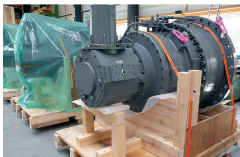
Boden mit Auflage aus Massivholz für Getriebe.
