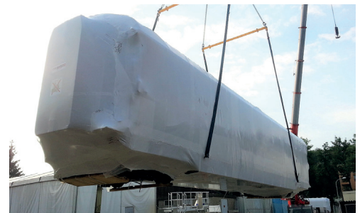
Schrumpfverpackung über 20 Meter lang (Eisenbahnwagen).
