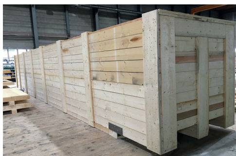
Massivholzkiste für 70 Tonnen Rotor.
