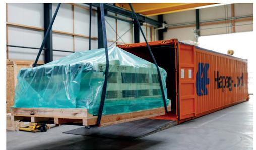
Stahlkonstruktion mit VCI-Folie umhüllt auf Container tauglichem Holzboden.
