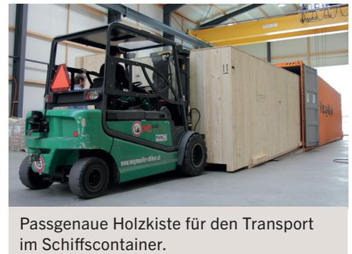
Passgenaue Holzkiste für den Transport im Schiffscontainer.
