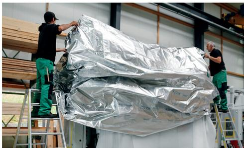
Korrosionsschutz mit Trockenmittelmethode (Alu-Verbundfolie).
