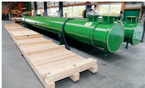
Boden aus Massivholz für Druckbehälter.
