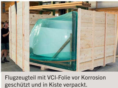
Flugzeugteil mit VCI-Folie vor Korrosion geschützt und in Kiste verpackt.
